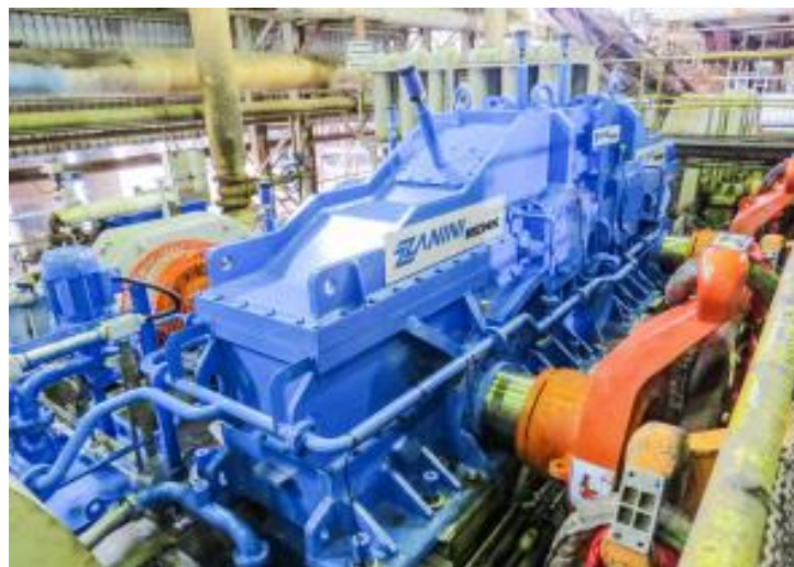
Figura 2.18: Redutor de Velocidade acoplado ao terno de Moenda em uma Usina
