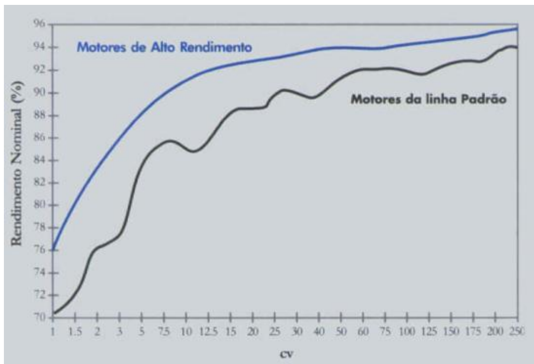
Figura 4.11: Motores de Alto rendimento x Rendimento Padrão.
