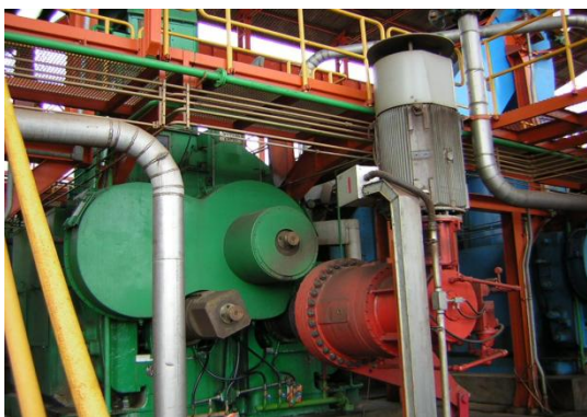
Figura 4.14: Motor acoplado a um rolo individual do terno de Moenda
